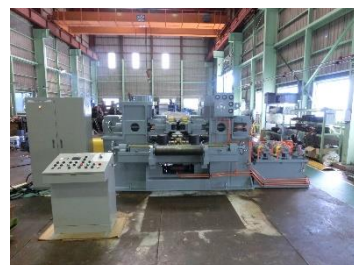
溶接形鋼ひずみ矯正装置
