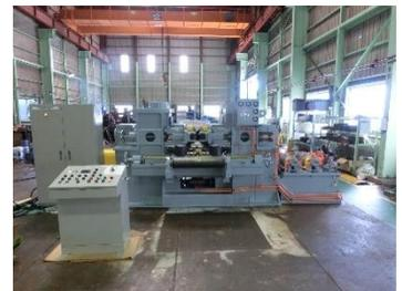
溶接形鋼ひずみ矯正装置
