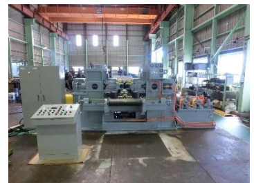
溶接形鋼ひずみ矯正装置
