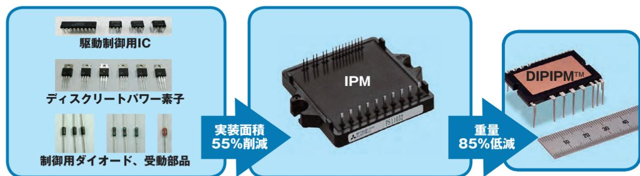
エアコン圧縮機制御用基板
