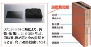
火災発生時の熱により、発泡樹脂が炭化層を形成。炭化層が扉と枠の隙間をふさぎ、高い断熱性能を発揮。
