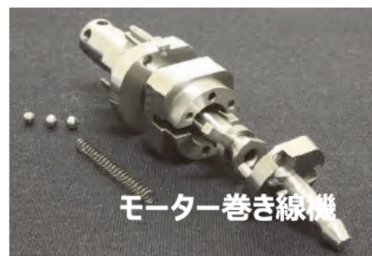
回転数を3,000RPMから15,000RPMへ大幅な機能向上が可能となった
