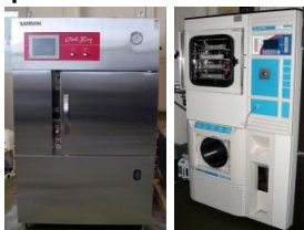
レトルト殺菌装置・真空凍結乾燥装置等を用いた加工食品試作
