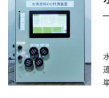
**水素燃料ガス計測装置**
