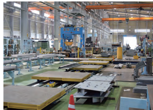
流れ生産方式の搬送台車
