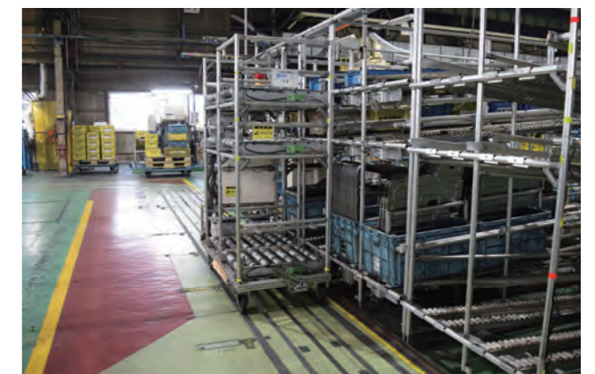
台車が必要な部材を載せ自動で搬送
