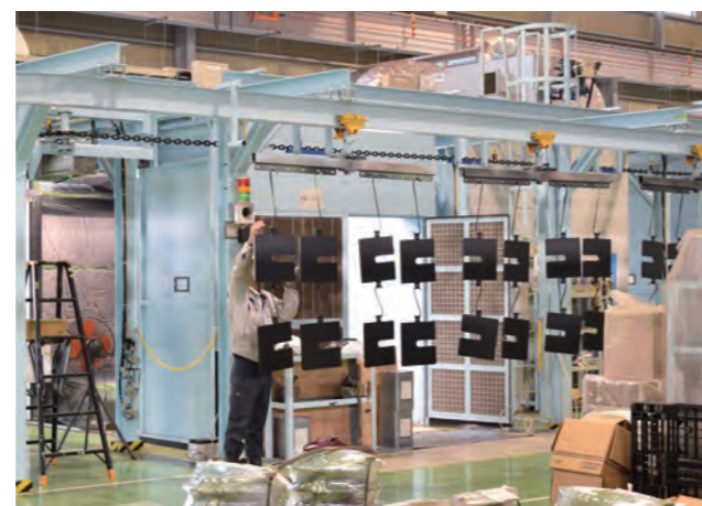
吊りハンガー式による自動塗装
