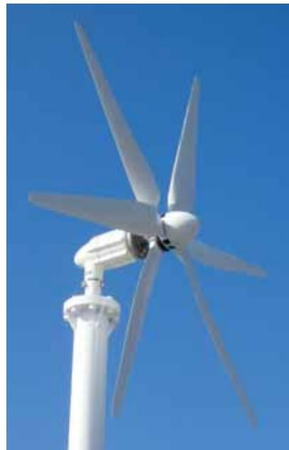
現在福岡市東区・久留米市で稼働中の1kW（直径2.2m）風車
