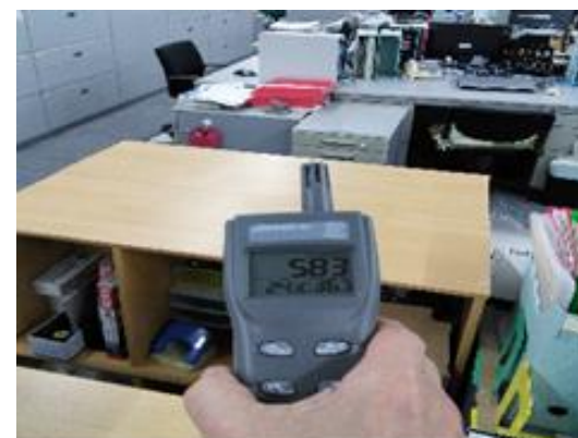
＜室内環境の測定(CO 2 計)＞
