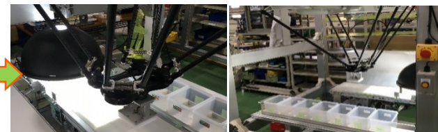
2020年3月：開発した大葉選別機主要機構部 【高性能画像処理とパラレルリンクの連携システム】
