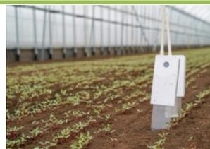
土壌水分センサーで遠隔灌水
