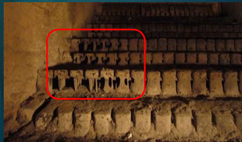
先端部に穴が開いた火格子
