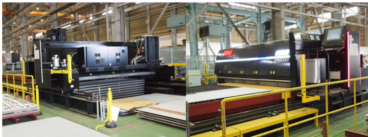
補助金を活用して更新したファイバーレーザー加工機
