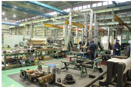
再生するシリンダーロッドのパーツの数々 シリンダーロッド：ショベルカーのアームに見られるような、部品同士をつなぎ先の部品へ油圧の力を伝えるもの。
