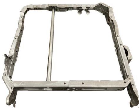
溶接レスの新工法でくみ上げた 自動車のシートフレーム
