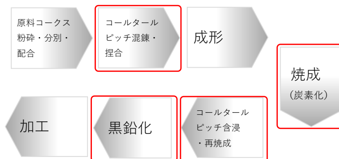
図表12 負極材（炭素粉末：人造黒鉛）製造工程
