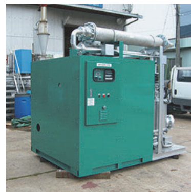
真空廃液濃縮装置
