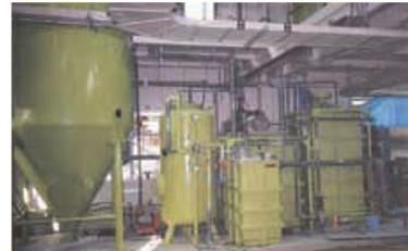
排水処理装置中型タイプ(6m³/時)
