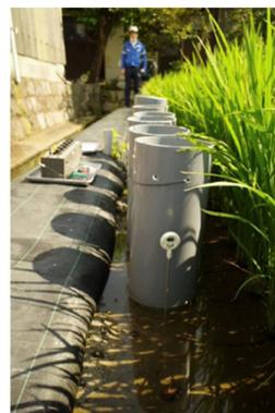
水田に設置した微生物燃料電池
