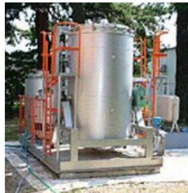
大型マイコン制御完全自発型炭化装置
