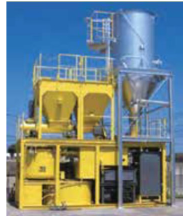
CCAS(改質フライアッシュ)製造プラント
