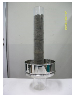
クリンカアッシュを充填した通水カラム
