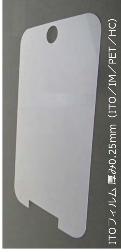
レーザー加工装置で切断した液晶ディスプレイフィルムの例
