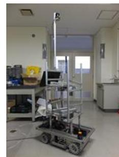
〔リフレクタを用いた位置測定システム〕〔無人全方向搬送システム〕
