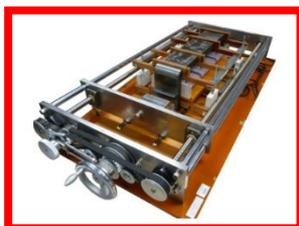
応力負荷型単板磁気試験器
