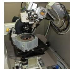
X線残留応力測定装置
