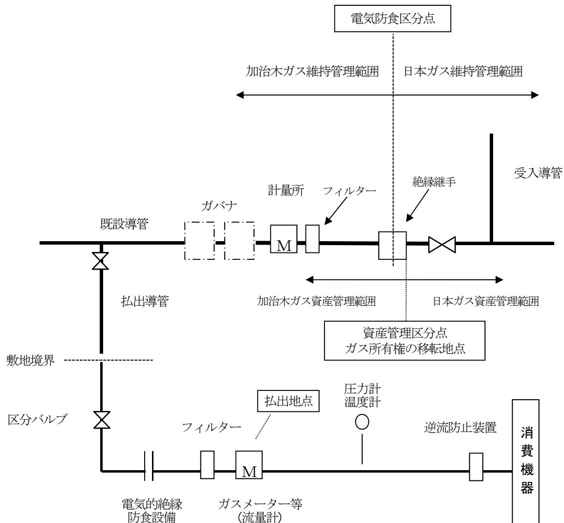
注：上図は概念図として参考に図示したものです。ガス製造形態や受入及び派出地点の位置等による差異が大きいため、詳細は個別に協議させていただきます。
