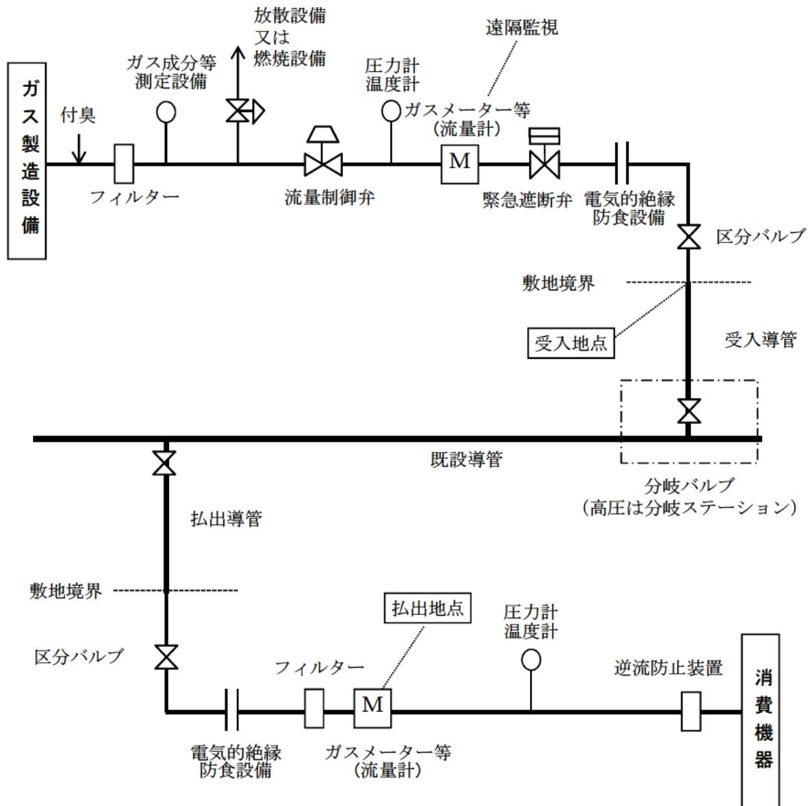
注：上図は概念図として参考に図示したものです。ガス製造形態や受入及び払出地点の位置等による差異が大きいため、詳細は個別に協議させていただきます。
