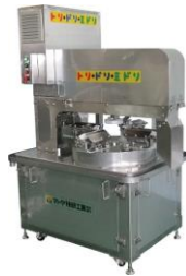
製品例：鶏せせり自動切剥機 「トリ・ドリ・ミドリ」
