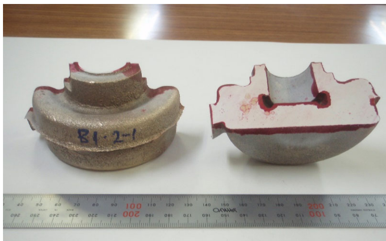
図.浸透探傷検査後の青銅鑄物部品
