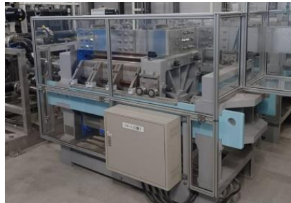
北海道電力に導入した水電解装置（2023年5月）（出所）日立造船（株）
