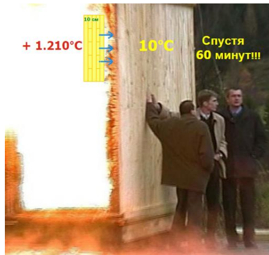
10cmのCLTにおける1時間後の温度変化
