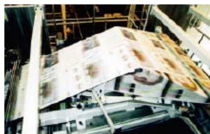
12万部/時で稼働中のSPS
